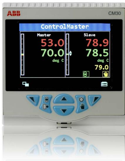
Fig. 2: Cascade template display
